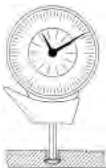
Schnelltaster Messuhr für Hinterschnittniet
